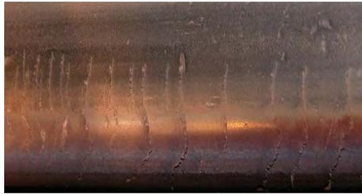
게이지코너 가공경화가 심하게 진행되어 박리로 발전되어 가는 상태
