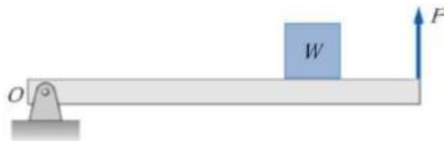
Fig. 1.1 평형해석은 하중 P를 결정할 것이다. 그러나 봉의 강도나 강성도를 결정하지는 못한다.
